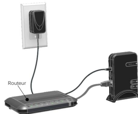
L'antenne interne du GT125 diffuse de façon optimale lorsque ce dernier est installé en position verticale tel qu'indiqué ci-dessus.
